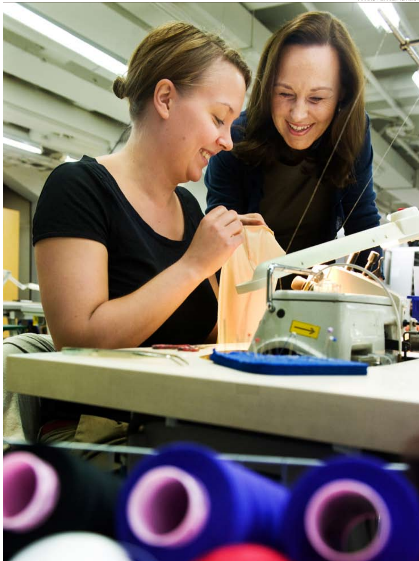
Ompelija Hanna Rekola (vas.) ja toimitusjohtaja Teija Toikka varmistavat, että painevaatteiden erikoissauma pitää. Kehon jokainen taipuva kohta on otettava huomioon ja ommeltava erikseen.
